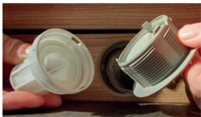
**2** Den Filter mit dem Endstück über die 3 Führungen verbinden und einrasten lassen (Pfeil auf Filter zeigt auf Einkerbung am Endstück).
